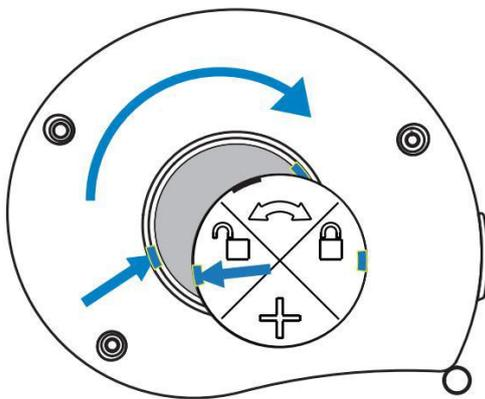
Conecte-se com segurança mirando na junta Snap-Fit, depois gire-o no sentido horário para travá-lo.
